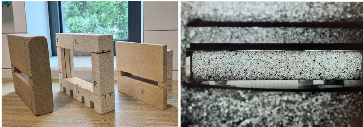
Abbildung 14: Darstellung der drei Komponenten der Ofenzustellung (von links nach rechts: Vermiculite-Platte, Neoceram®-Glas im Feuerleichtstein-Rahmen, gefalzter Schamottestein). Der rechte Teil des Bildes zeigt die Kameraperspektive auf die Probe während der Messungen durch das Beobachtungsfenster.
