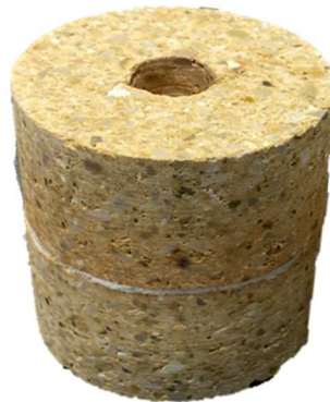
Abbildung 40: Zweiteilige Bauxitsteinprobe mit einer Mörtelfuge für DE-Prüfung
