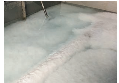
Herstellung von Filterkerzen nach dem Vakuumformverfahren
