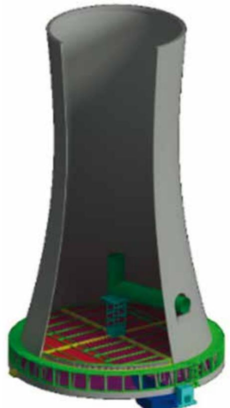
Für die Errichtung der Schachtschalen der Naturzugkühltürme hat die DOMINION ein eigenes Zugangs- und Kletterschalungssystem entwickelt und eingesetzt. Das Klettersystem wird an der Schaftwand verankert und klettert mittels Hydraulikhebern in einzelnen Segmenten an der Schaftwand entlang. Von den Arbeitsebenen kann man die Schalung
