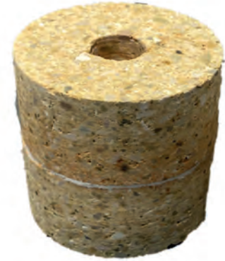
Abbildung 13: Zweiteilige Bauxitsteinprobe mit einer Mörtelfuge für DE-Prüfung
